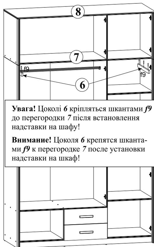
**Увага!** Цоколи 6 кріпляться шкантами *f9* до перегородки 7 після встановлення надставки на шафу!
