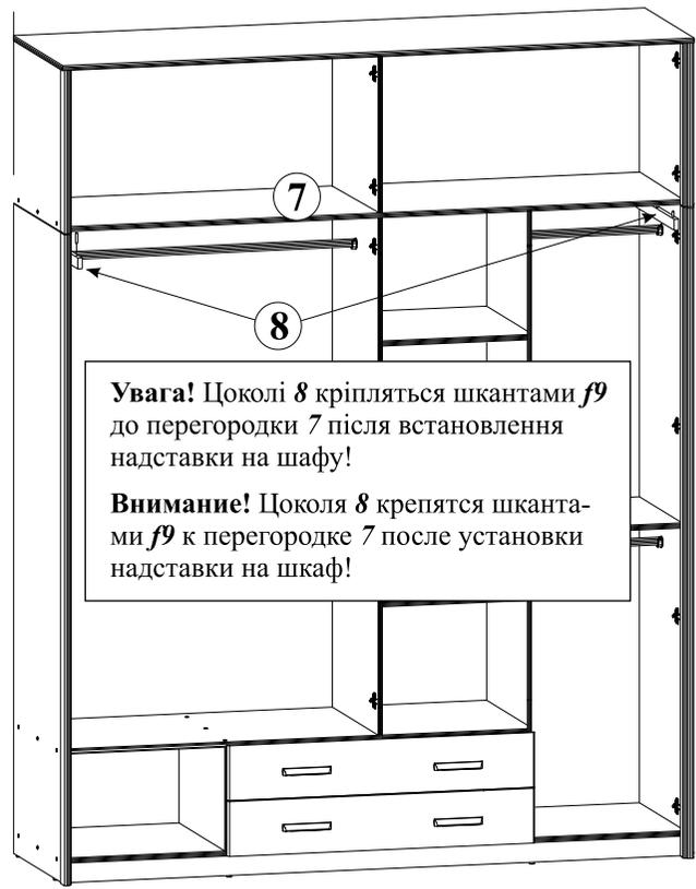
**Увага!** Цоколі 8 кріпляться шкантами *f9* до перегородки 7 після встановлення надставки на шафу!
