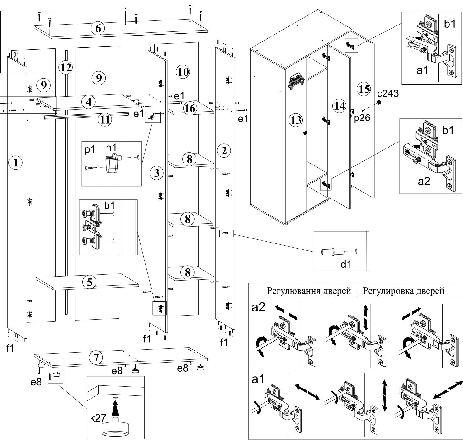
Регулювання дверей | Регулировка дверей
